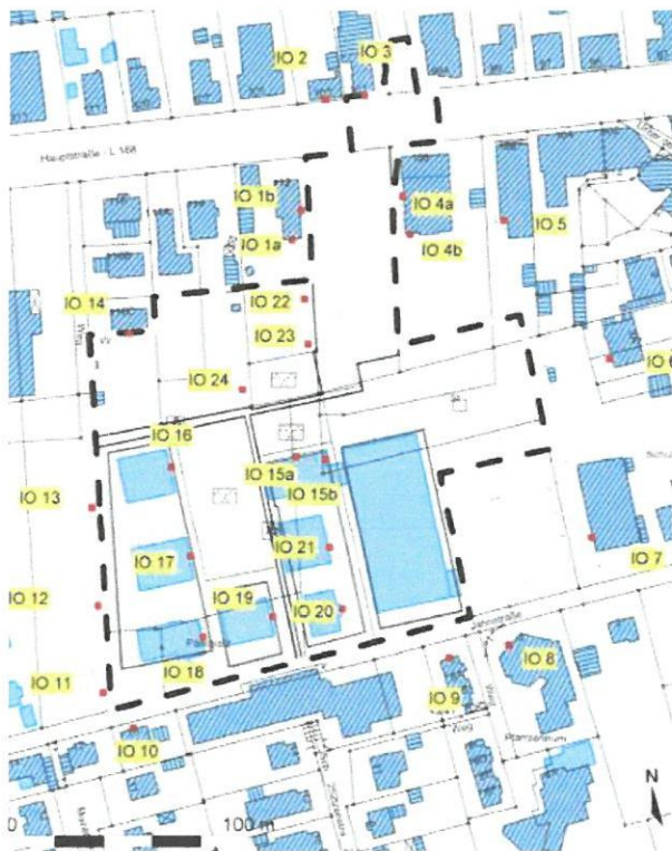
Abbildung aus der Schallimmissionsprognose: Lageplan mit Immissionsorten
